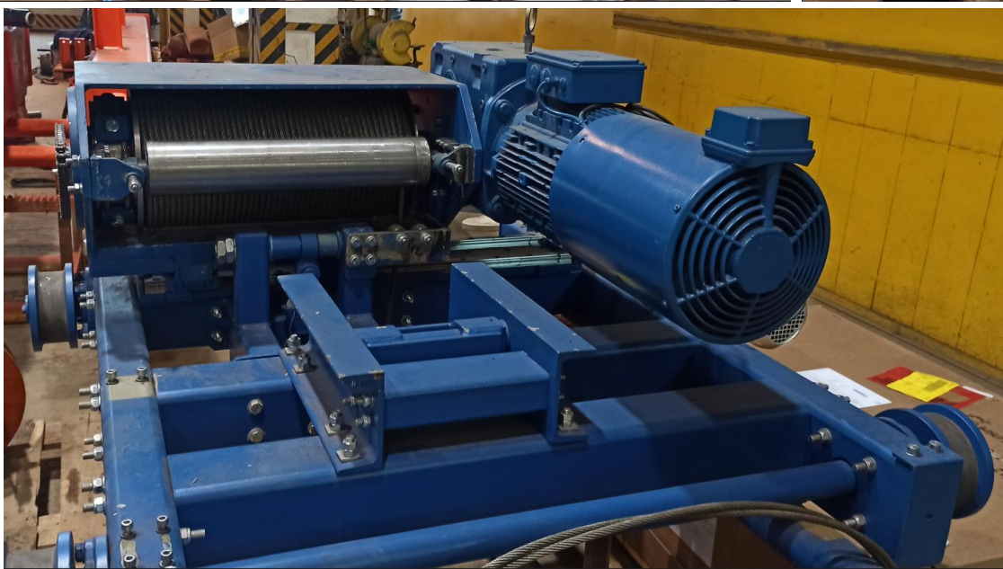
Rys.11. Produkcja i montaż prototypowych wciągarek (fragment dokumentacji HAK)
