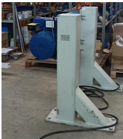
Rys.14. Widok wciągarki podczas testów ruchowych na stanowisku badawczym (fragment dokumentacji HAK)
