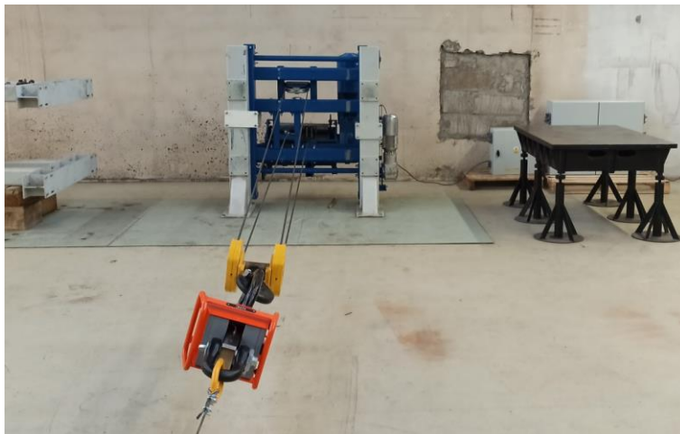
Rys.15. Widok wciągarki podczas testów ruchowych na stanowisku badawczym (fragment dokumentacji HAK)
