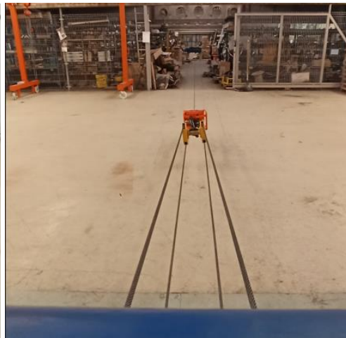
Rys.15. Widok wciągarki podczas testów ruchowych na stanowisku badawczym (fragment dokumentacji HAK)
