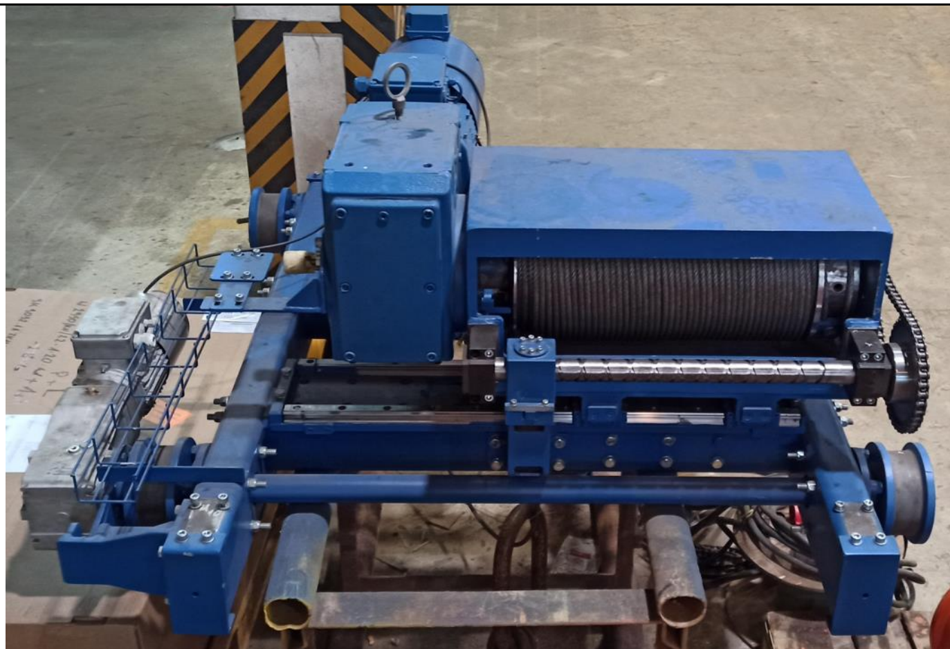
Rys.12. Produkcja i montaż prototypowych wciągarek (fragment dokumentacji HAK)
